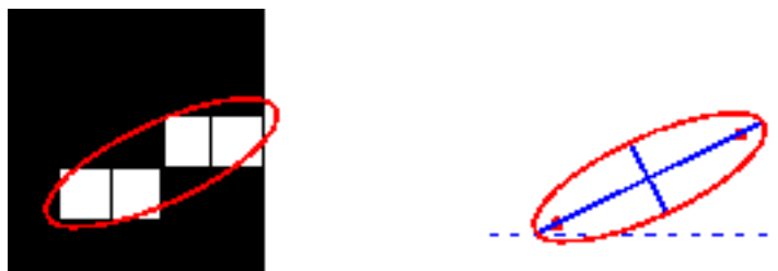
Figur 2.4: En ellips vars andramoment \mu_{02} och \mu_{20} är samma som objektets. Excentriciteten är kvoten mellan avståndet mellan fokalpunkterna (de två prickarna på diagonalen) och den längsta axeln.
